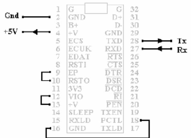
Le module USBMOD3 est composé de 2x16 pattes au format DIL32. Pour fonctionner correctement, il est nécessaire de réaliser quelques ponts. Vu du PC, le module est traité comme un port COM série. Il est possible d'ajouter deux LED pour visualiser le transfert via les pin 15 et 17 avec résistances de 330 Ohms reliées à +V.
